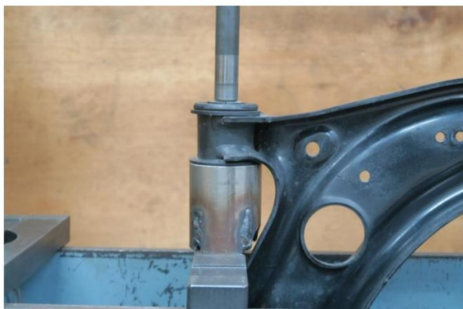
3. フロントコントロールアームを図のようにセットし、純正ブッシュのセンター部分にあるスチールカラーを、適切な鉄棒を使用して油圧プレス機で押し下げて抜き取ります。
