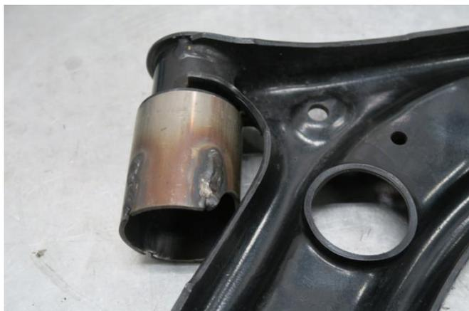
1. フロント側の純正ゴム製ブッシュを取り外すために必要な台座を準備します。台座はコントロールアーム側の形状およびブッシュを落とせる径を持つものを使用する必要があります。スチール製パイプなどを流用するか、専用の工具をご使用ください。
