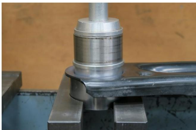
13. iSWEEP ピロボールブッシュの外周部分に均等に圧力がかかるように油圧プレス機を使用してピロボールブッシュのリブがフロントコントロールアームに当たるまでゆっくりと圧入してください。
