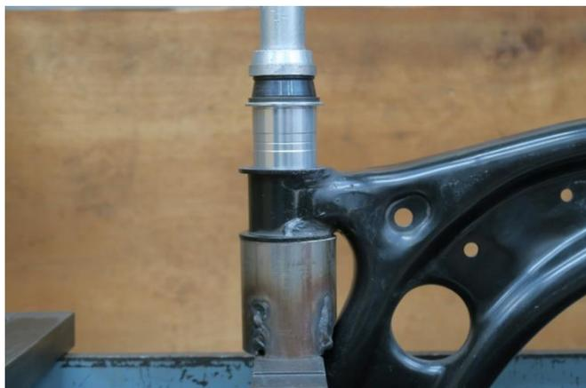
7. iSWEEP ピロボールブッシュの外周部分に均等に圧力がかかるように油圧プレス機を使用してピロボールブッシュのリブがフロントコントロールアームに当たるまでゆっくりと圧入してください。
