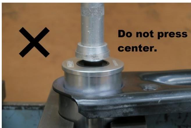
11. 【注意】 iSWEEP ピロボールブッシュのセンター部分はボールジョイント構造になっているため、絶対にセンター部分に圧力をかけて圧入しないでください。圧力をかけると、ピロボールジョイントが破損します。
