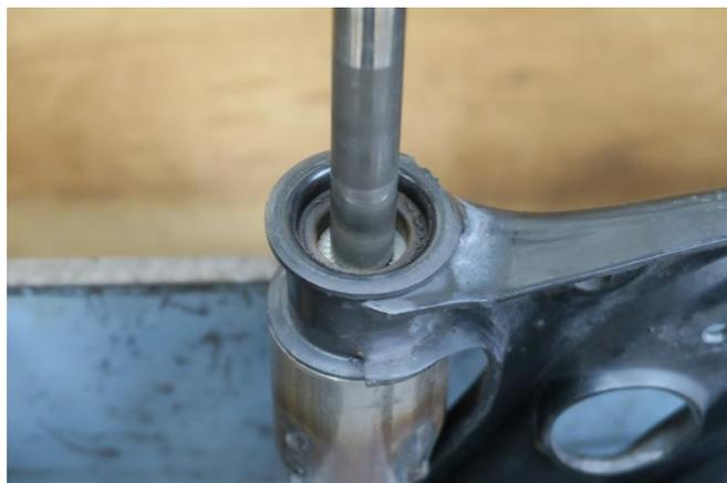
4. 油圧プレス機で、ゴムブッシュ外周のリブが内部に引き込まれ、下側台座内に落ちて抜けるまで押し込みます。
