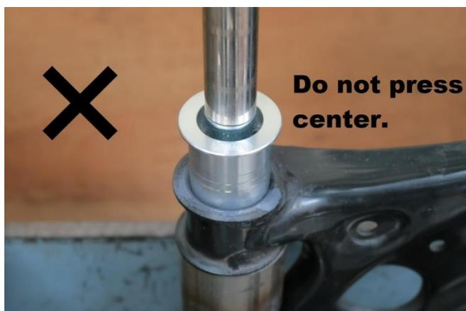
5. 【注意】 iSWEEP ピロボールブッシュのセンター部分はボールジョイント構造になっているため、絶対にセンター部分に圧力をかけて圧入しないでください。圧力をかけると、ピロボールジョイントが破損します。
