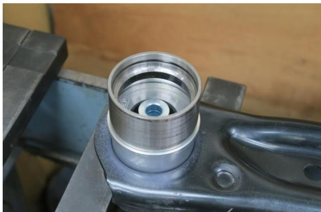
12. iSWEEP ピロボールブッシュのセンター部分(ボールジョイント)に圧力がかからないよう、ピロボールブッシュの外周部分にフィットするカラーを使用してください。
