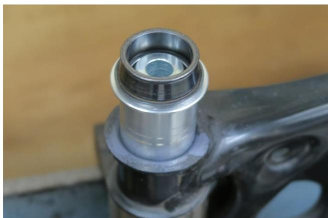
6. iSWEEP ピロボールブッシュのセンター部分(ボールジョイント)に圧力がかからないよう、ピロボールブッシュの外周部分にフィットするカラーを使用してください。
