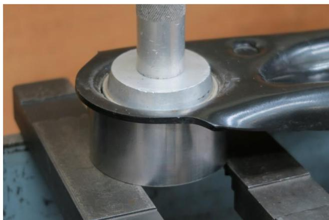
10. アタッチメントの外径が大きい場合、フロントコントロールアームにアタッチメントがはまってしまうため、外径に注意して純正ブッシュを下方方向に抜き取ってください。この際、下側のプレス台にブッシュが先に当たると抜けないため、台座内部のスペースとプレス台との干渉に注意してください。
