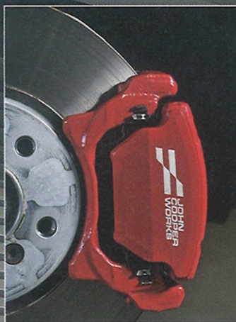
F66JCWのフロントキャリパーは片押し式。このキャリパーに合わせたパッドを新開発した。
