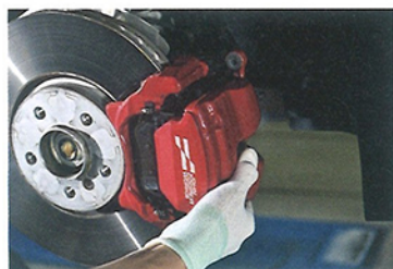
対向ピストン式よりもサイズが小さいのでホイールに対するクリアランスに余裕ができたF66 JCW。
