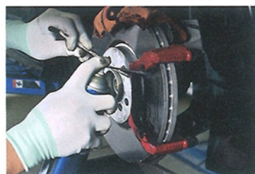
パッド交換をする際には汚れなどを徹底的に除去する。あたり前の、しかしとても重要な作業。
