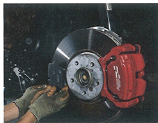
装着したのはテスト品なので、パッドにIS1500のロゴは印刷されていない。バックプレートの形状などに問題はないか、ガタつきなどは無いかなど確認しながら装着をし、キャリパーをセットしていけば作業終了だ。
