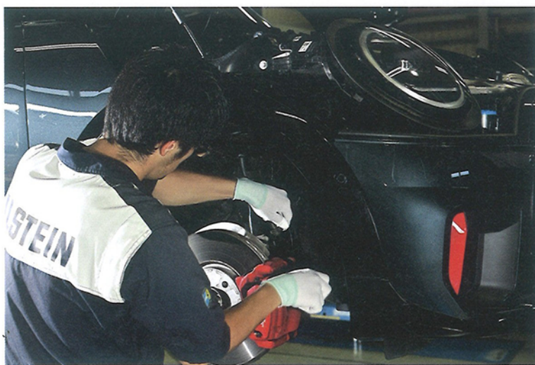
F66JCWのフロントキャリパーは片押し式。このキャリパーに合わせたパッドを新開発した。
