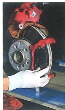
パッド交換をする際には汚れなどを徹底的に除去する。あたり前の、しかしとても重要な作業。
