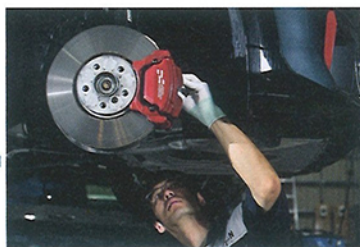
片押し式フロントキャリパーはごく一般的なカタチをしているのでスライドボルトを抜き取る。
