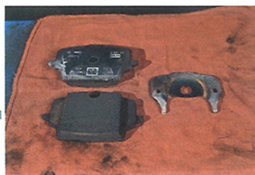
これが純正ブレーキパッド。今回はこれに換えて低ダストタイプのIS1500を装着することとした。
