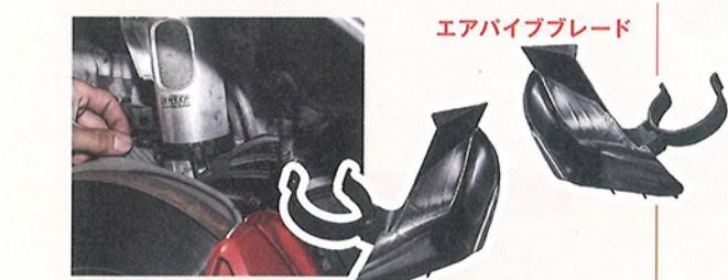
エアバイブブレードはMINI JCW GP (F56) に装着されているチューニングパーツ。ブレーキダクトから入ってきた空気
