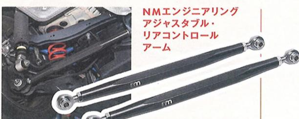
MINIのアライメントの調整範囲を格段に広げてくれるのが調整式のコントロールアームだ。このアイテムの装着と適正
