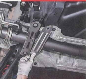
ドイツ車のほとんどがセンターやリアに補強プレートを追加装着してボディ剛性を高めている。プレースなどと呼ばれるようになる以前は、純正のプレートを重ねて装着するチューニングも行われていたが、最近では専用バーツを開発するメーカーも増加。iSWEEPはスチール製のボックス構造を採用し、高い剛性と軽量化を両立させている。
