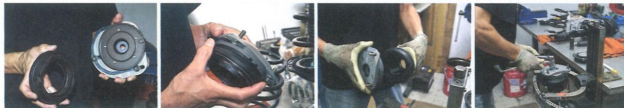
アッパーマウントとスライドプレート、スペーサーで構成されているが、組み合わせたサイズは純正アッパーと同じになる。ラバーマウントを介してショックを固定するので、微細な振動はしっかりと吸収されるし、ピロのように異音が出ることもない。
