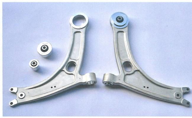
ピロボールブッシュは回転方向にだけスムーズに動くため、サスペンションの機能を高め、ブレーキングや走行中のアライメント変化を抑制。走行安定性と操舵性が格段に向上する。
