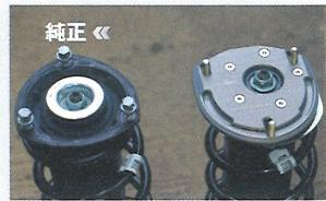
純正アッパーマウントと同サイズで製作されているため、純正流用が基本となる他社製サスペンションにも使用可能。工作精度が高く剛性面も不安なし。
