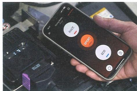
切り替えモードは、エコとスポーツ、レースの3つ。現状モード内の切り替えは1~5の5段階だが、内部的にはヨーロッパ仕様ハイオクガソリン用の6と7というモードが用意されている。
