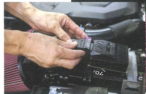
各種センサーのコネクターに専用ハーネスのコネクターを接続し、最後に本体にコネクターをはめれば取り付けは完了。ここらへんはプロに作業を任せるとベターだ。
